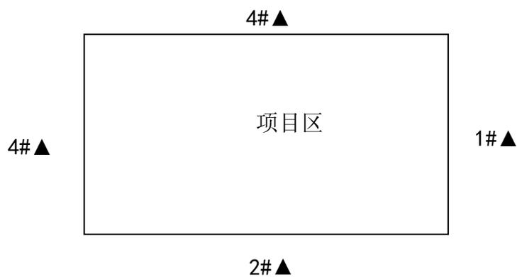
图 7-2 噪声监测布点图 (“▲”厂界噪声监测点位)
